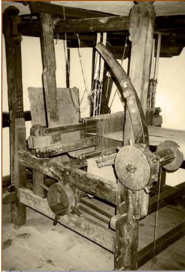
Traditioneel klein weefgetouw typisch voor het weven van linnen voor eigen gebruik
